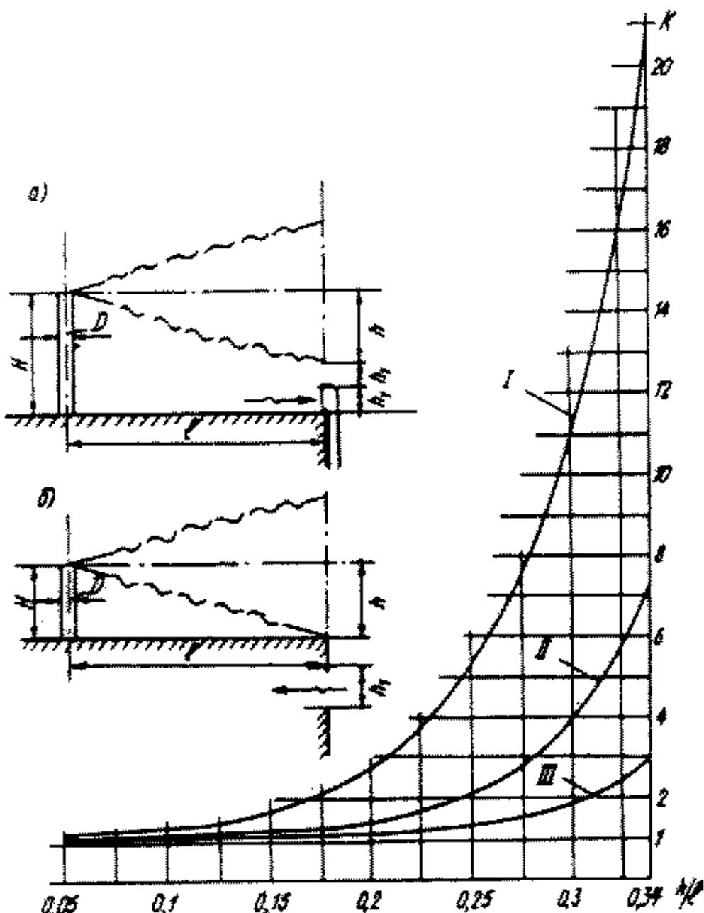
а - расположение источника над зоной всасывания наружного воздуха приемным устройством (высота трубы источника  $H = 2h(1)+h$ );
